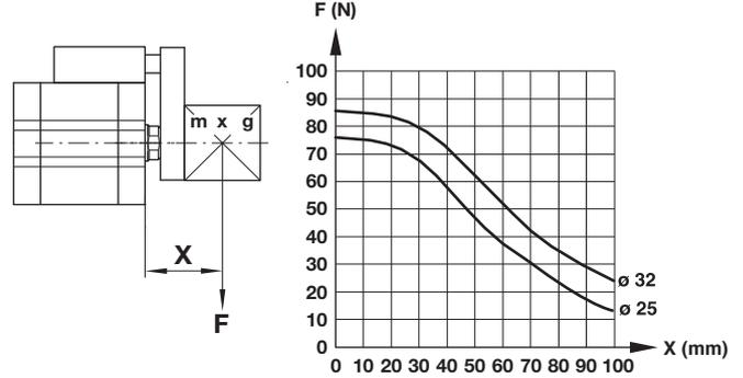
**RA/192000/N4 - Zylinder mit Gleitführung**
