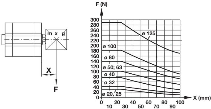
**RA/192000/N6 - Zylinder mit Führungsschlitten**
