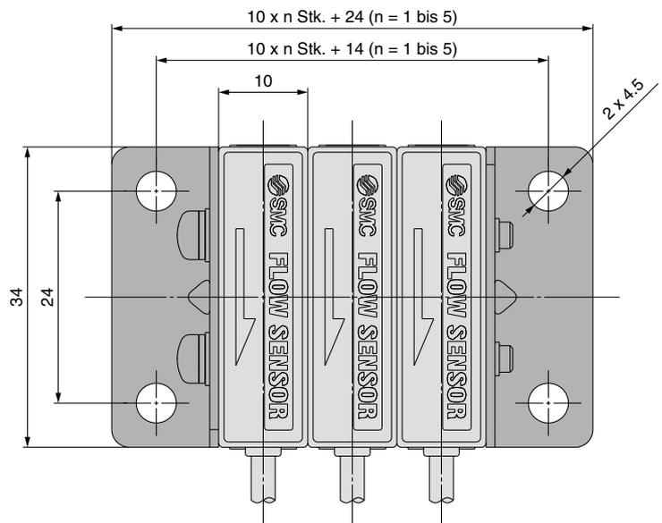
Die obigen Abmessungen gelten für den PFMV5□□-1. PFMV5□□F-1 hat die gleichen Abmessungen.
