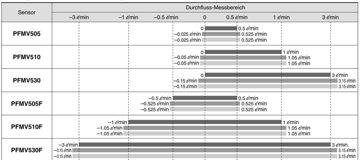
Die im Diagramm angezeigten Werte sind der Durchfluss-Anzeigebereich und der Durchfluss-Einstellbereich, wenn die Serien PFMV5 und PFMV3 angeschlossen sind
