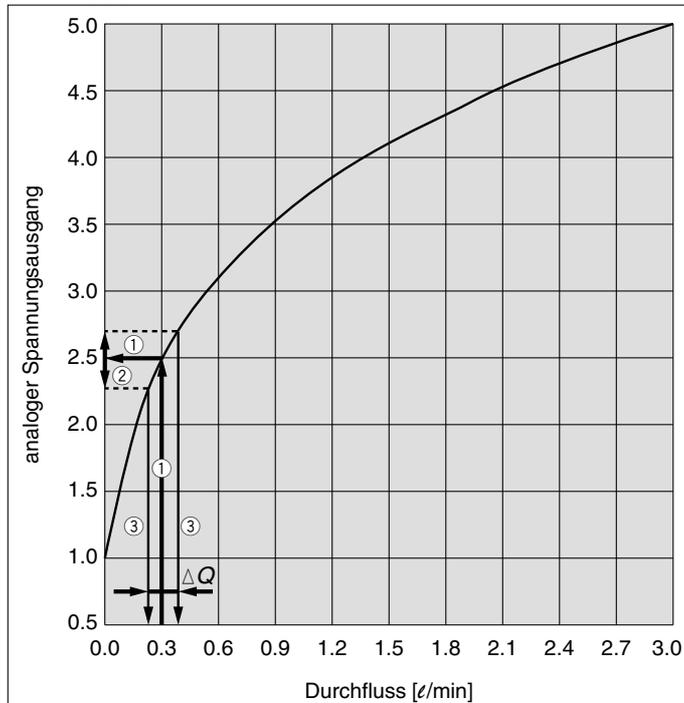
Berechnen Sie bei Wahl der Funktion zur Durchflussanzeige für die Serie PFMV3 die Wiederholgenauigkeit ausgehend von den Analogausgang-Kennlinien (Seite 5).
